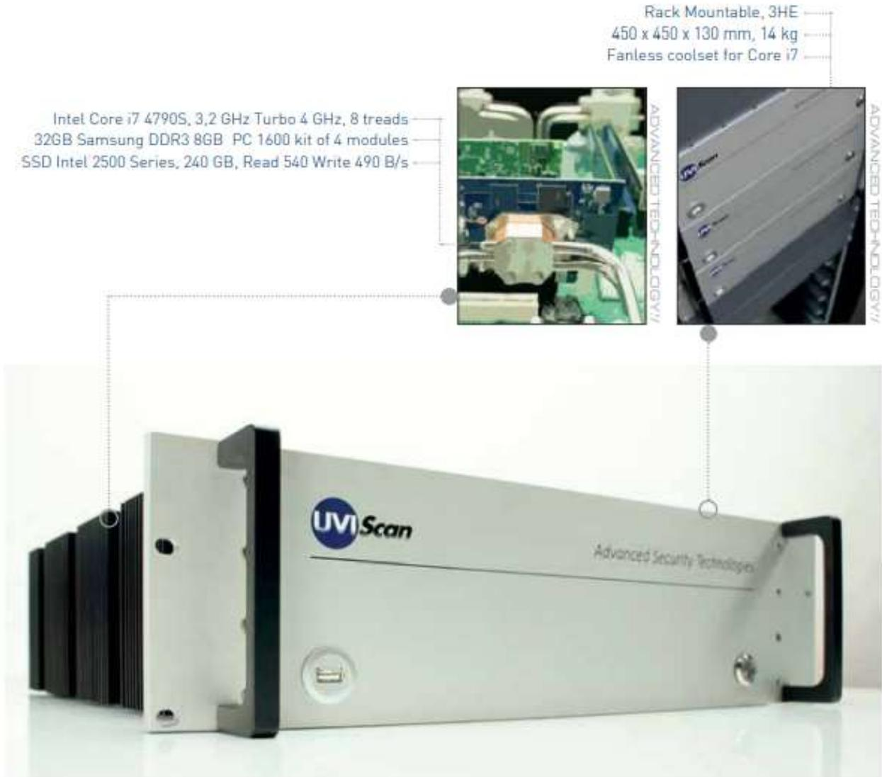
Plus de problèmes de poussière, plus de ventilateurs cassés. L'unité de traitement UVIScan est un ordinateur industriel à la pointe de la technologie, adapté à la technologie de balayage sous véhicule UVIScan. L'unité de traitement est dotée d'un châssis industriel au design esthétique en aluminium brossé et de refroidissement externes.
